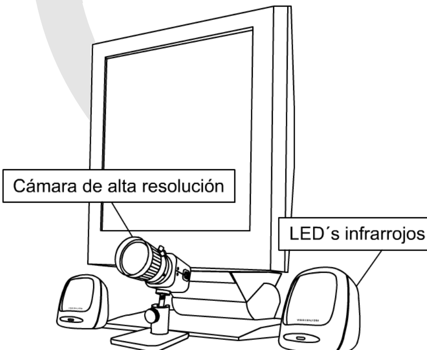
La cámara enfoca el ojo del usuario y el programa informático calcula la dirección de la mirada en la pantalla del ordenador.
