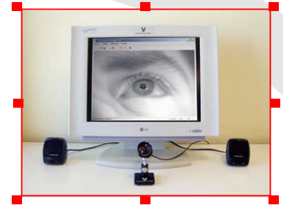
Componentes de VisioAnalyzer: Cámara de alta precisión (centro) y led's infrarrojos (a los lados)
